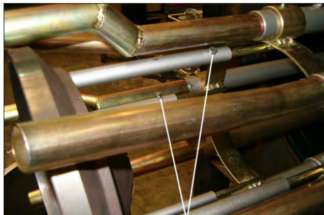
Разблокировать винты для того, чтобы можно было подвинуть диск пламени
